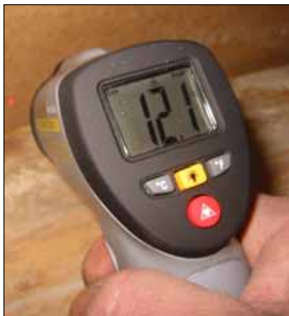
Pintalämpötilamittarilla pystytään havaitsemaan rakenteiden vuotokohtat.
