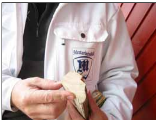
Yli kuusikymmentä vuotta käytössä ollut hyvälaatuisesta puusta valmistettu ikkunanpuite on puuosiltaan vielä aivan virheetön.
